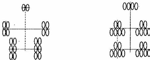
Abbildung 1: Darstellung Fahrwerk A380-800 und C-5 aus FAA Order 5300.7, 2005
